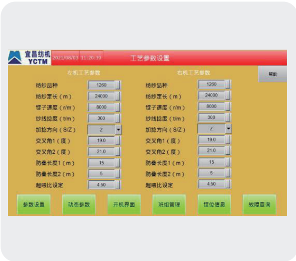
全新电控系统： 断纱传感器、节能卡/控制卡的全面 升级，操作界面更新，提高生产稳定性
