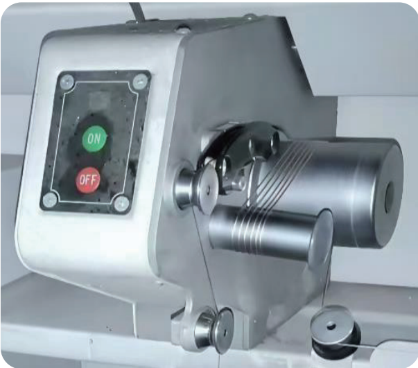
新设计超喂组件： 铸铝超喂箱，外形紧凑、运行稳定，优 化大/小超喂辊表面工艺，提高强力
